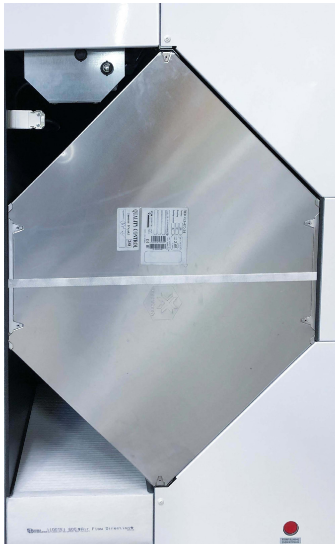
Motströmsvärmväxlare i aluminium med mer än 80% temperaturverkningsgrad.
