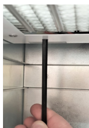
Återställning av överhettningsskydd. OBS med ett trubbigt verktyg
